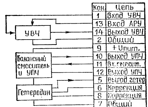
Функциональная схема микросхемы K157ХА1
